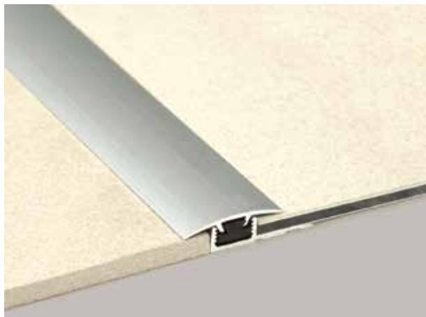
Patentiertes Verbindungsprofil für koplanare Böden. Innovativ, denn mit diesem raffinierten System mit Clips aus Resinil können durch Drehung auch kleine Höhenunterschiede bis zu 1,5mm ausgeglichen werden.
